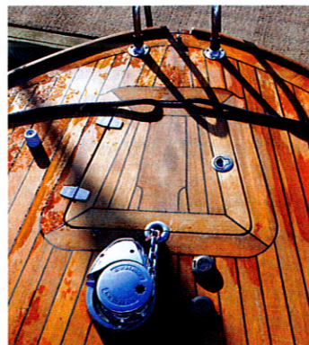
Kun ankkuria tarvitaan, se nostetaan telineineen ylös boksista. Kun se on piilossa, ei keulaan jää törröttämään metalliosia.
