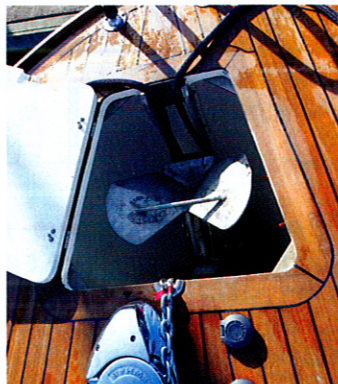
Kun ankkuria tarvitaan, se nostetaan telineineen ylös boksista. Kun se on piilossa, ei keulaan jää törröttämään metalliosia.
